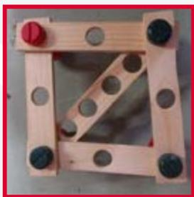
Le triangle résiste tandis que le carré cède à moins que les angles soient renforcés. Comment ? En utilisant une poutre diagonale, ce qui revient à construire deux triangles.
