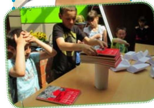
Les élèves de 3ème et 4ème construisent eux-mêmes les piliers en suivant un protocole. Ensuite, les élèves prennent des livres ou objets identiques (de même masse) et les déposent un à un jusqu'à ce que le pilier s'écroule. Ils comptent les livres posés. Ils répètent l'action avec les autres piliers et comparent les résultats.
