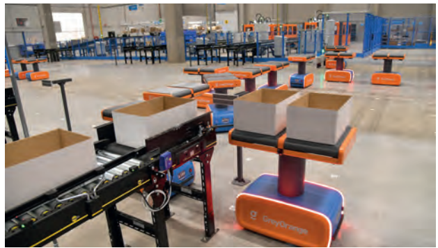
Un AMR récupère les boîtes vides pour les amener à l'opérateur de la station de picking.
