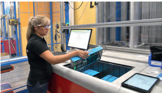
Lorsqu'un produit est commandé, un robot AutoStore apporte le bac avec les produits stockés à l'opérateur.
