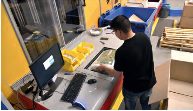
A leur arrivée, les produits sont contrôlés et chargés à l'arrière de l'AutoStore par un opérateur.
