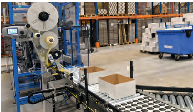
Les caisses sont fabriquées sur place par trois machines automatiques Lantech.
