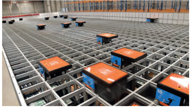
Des robots amènent les bacs 60x40x30 avec les produits entrants vers leur lieu de stockage.
