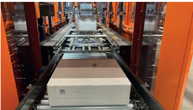
L'AMR déplace la boîte pleine vers l'une des deux machines d'emballage Jivaro, où elle est découpée sur mesure, fermée et étiquetée.
