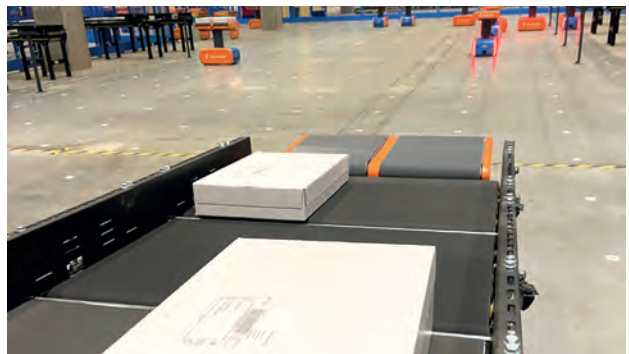
Un AMR amène les boîtes fermées à l'un des cinq points de chargement. Elles y sont chargées, par transporteur, dans des conteneurs à roulettes.
