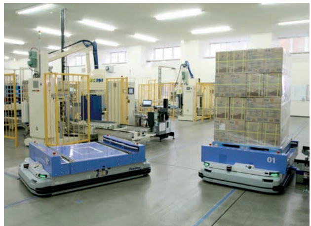
Unit Load AGV : efficace et flexible en combinaison avec des convoyeurs fixes et du stockage.
