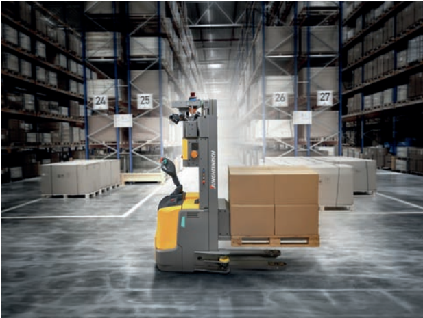
Forklift AGV : souvent sous la forme hybride.
