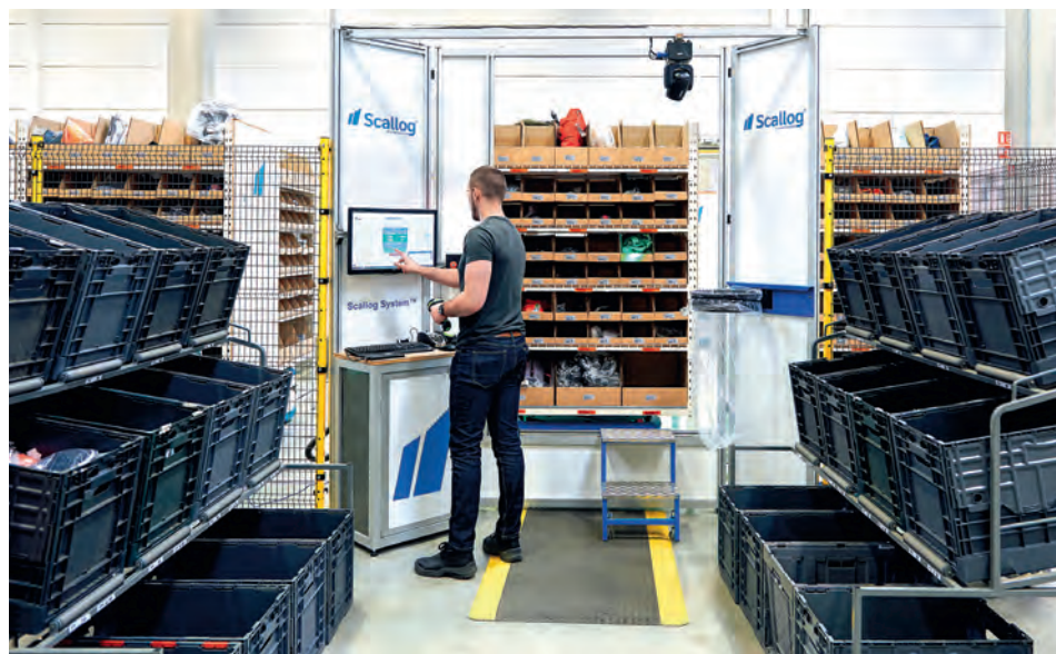
Le préparateur de commandes se trouve à l'extérieur de la zone fermée où les étagères sont déplacées. Il est souvent aidé par un système pick-to-light.
