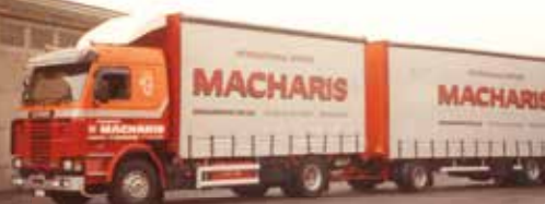
Belle combinaison grand volume que ce porteur Scania R113 4X2 Topline, avec une longue remorque à trois essieux et d'une hauteur intérieure de 3 mètres.
