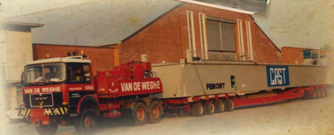
Très bel ensemble composé du tracteur-porteur MAN F90 6X6 et d'une semi-remorque avec berceau, en 4 + 4 essieux.
