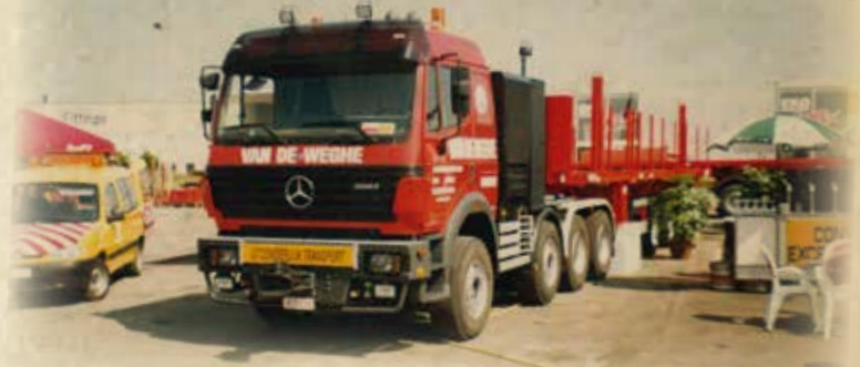
Mercedes SKN 4453 avec semi-remorque Nootboom à quatre essieux directionnels.
