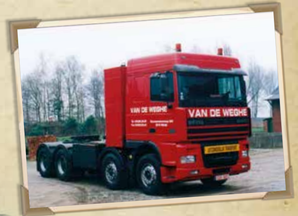
Voici un véhicule très rare : un tracteur DAF SpaceCab 8X4, en version tracteur de 150 tonnes.
