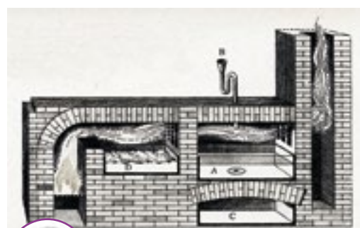
Le procédé de Nicolas Leblanc pour extraire la soude (c-à-d le carbonate de sodium) du sel marin (chlorure de sodium).
