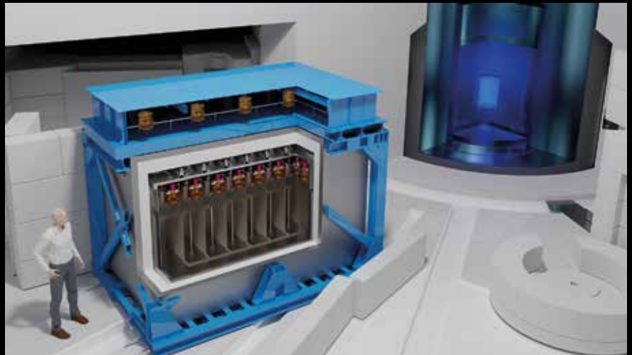
Le détecteur de neutrinos est constitué de 6 cellules identiques (à gauche) remplies d'un liquide scintillant, situées de 9 à 11 m du réacteur de recherche (à droite).
