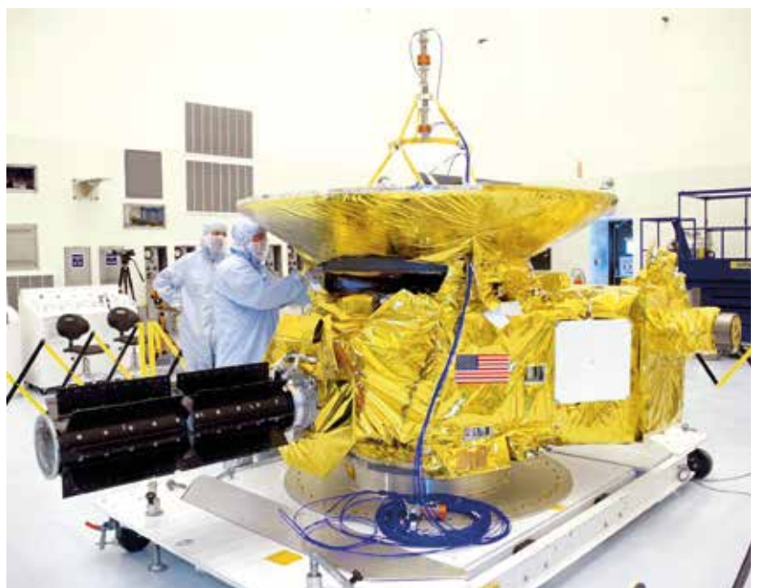
Assemblage de la sonde New Horizons en 2005 intégrant ici un modèle grandeur nature du GTR, remplacé ensuite par le vrai générateur peu avant son lancement.
