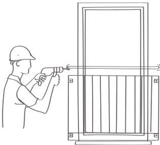
Non. Un garde-corps doit être fixé dans une structure ayant une fonction portante (paroi intérieure du mur creux) ou dans un élément apte à reporter les charges à la structure portante (menuiserie correctement ancrée).
