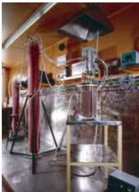
Pilote de détoxification biotechnologique de boues de peinture, procédé BPSD. (Photo: Ruhr-Universität Bochum).
