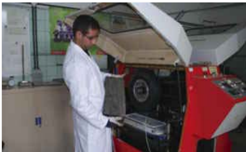
Essai d'orniérage sur enrobés bitumeux.
