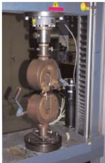
*La résistance mécanique des panneaux de multiplex est testée, en suivant les normes, en vue du marquage CE.*
