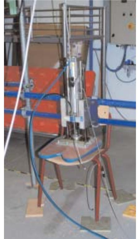
**Une chaise en cours d'essais pour vérifier si sa résistance mécanique répond aux spécifications de la norme.**
