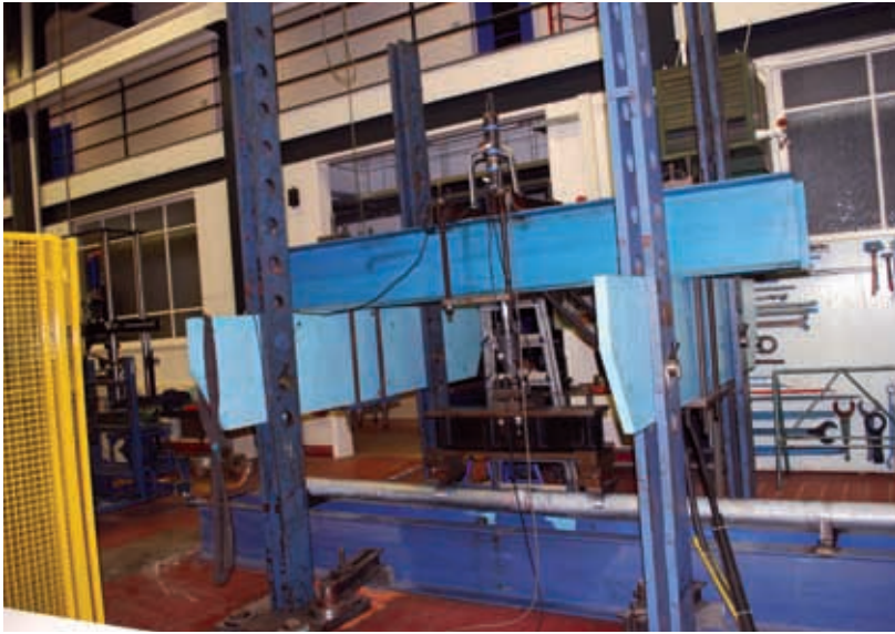
Vue d'un montage destiné à étudier le comportement d'un tube soumis à une charge de fatigue.
