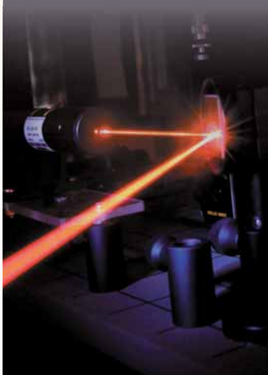
Laser à gaz: un hélium-néon émettant une lumière rouge (schéma 3 et photo ci-dessous)
