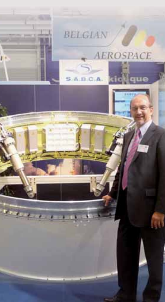
Base du 1 er étage du lanceur européen Vega qui est piloté par le sous-système SABCA de servo-commandes électro-mécaniques.
