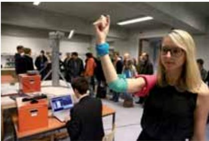
*Ce bras peut reproduire les mouvements humains grâce à 3 capteurs placés sur le bras de l'opérateur. Une caméra (récupérée sur une console de jeux Xbox) capture les gestes en 3D et envoie les informations vers le bras robot. Celui-ci est équipé d'une main à 3 doigts articulés qui peut saisir des objets.*
