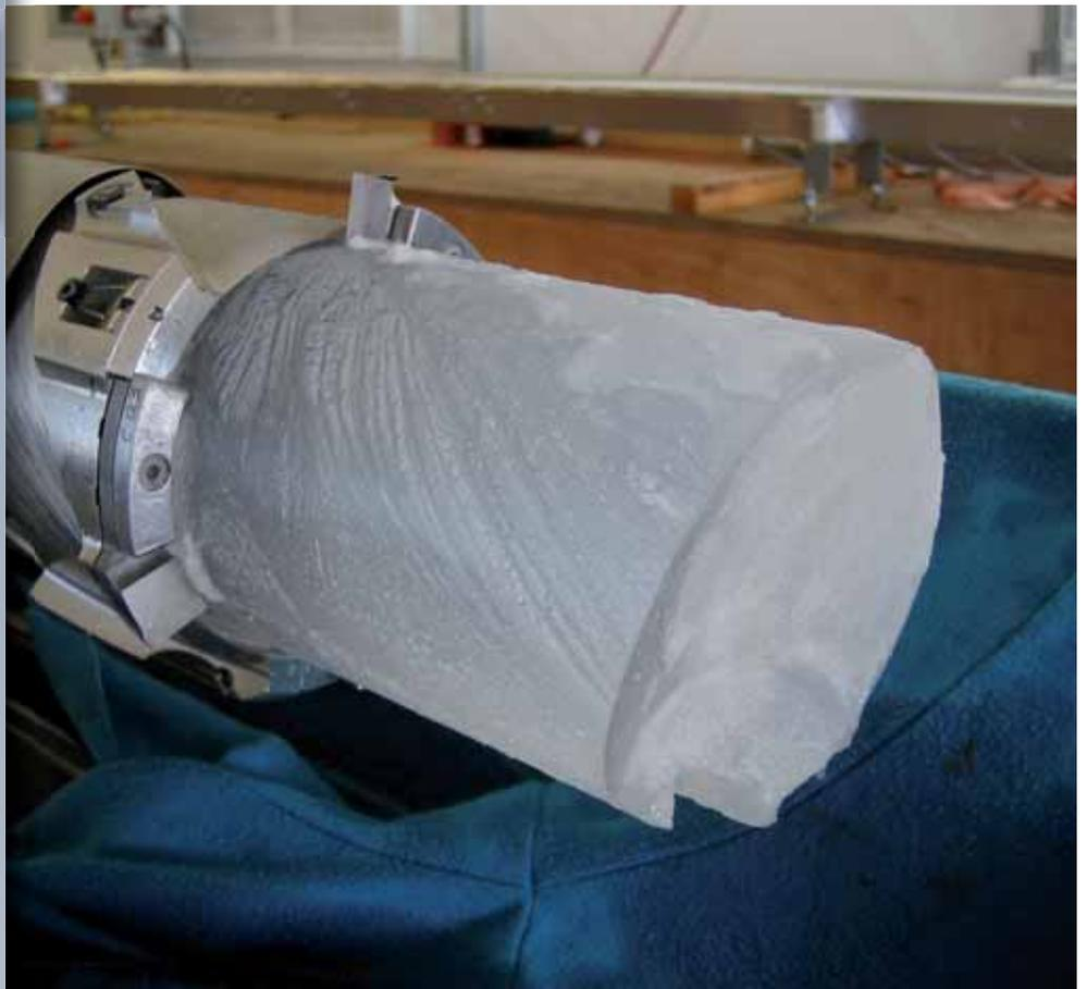
*Carotte glaciaire, à la sortie de la tige de forage, extraite dans le cadre du programme EPICA, au Dôme C sur la base franco-italienne Concordia, en Antarctique. En analysant cette glace antarctique, les chercheurs français du LSCE et du LGGE ont reconstitué, sur 800 000 ans, l'évolution des teneurs en CO<sub>2</sub> et méthane, les deux principaux gaz à effet de serre après la vapeur d'eau.*
