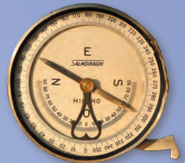
2 Boussole à inclinomètre graduée en degrés, pour mesurer l'inclinaison magnétique (géomètre Salmoiraghi).
