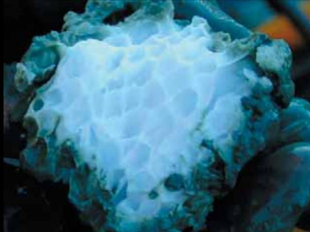
Bloc d'hydrate de gaz (clathrate) trouvé lors d'une expédition scientifique par le navire de recherche allemand FS SONNE au large de l'Oregon, à une profondeur d'environ 1200 mètres. Cet hydrate de méthane était enfoui dans le premier mètre du sédiment. Il présente une structure particulière vaguement en nid d'abeille quand il fond.
