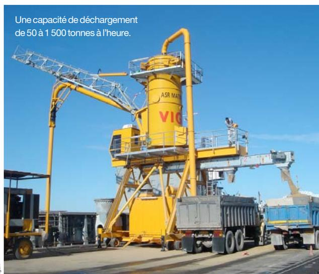
Une capacité de déchargement de 50 à 1 500 tonnes à l'heure.
