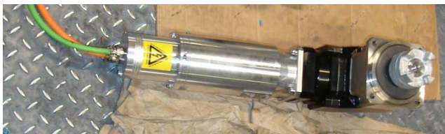
Fig.6: L'un des six servomoteurs muni de son renvoi d'angle, de son réducteur de vitesse et de son pignon d'accouplement.
