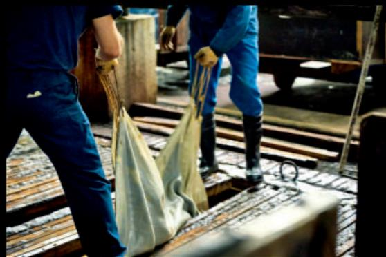
Les peaux plongées dans les tanins sont suspendues à des barres de bois. Les cuirs sont placés en basserie, un mois ou dans des foulons de tannage (une semaine et demi). Le premier traitement est indiqué pour des cuirs d'une épaisseur supérieure à 4 mm.
